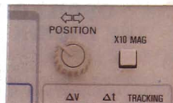
Fig. 9 - Per ottenere un'espansione di 10 volte della traccia occorre premere il pulsante X10MAG, situato di fianco al comando di posizionamento orizzontale.
