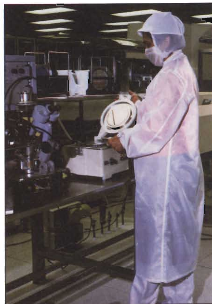
Preparazione della fetta di silicio prima dell'operazione di segatura in "clear room", alla TEXAS INSTRUMENTS di Rieti.
