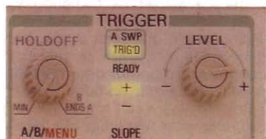
Fig. 8 - Il comando per variare il periodo di hold-off si trova nel riquadro che raggruppa i comandi di trigger.
