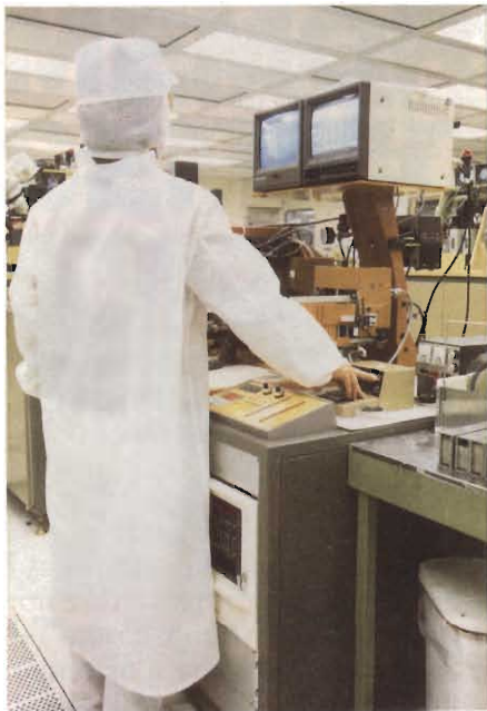
Controllo della operazione di bonding alla fabbrica di semiconduttori della TEXAS INSTRUMENTS di Rieti.
