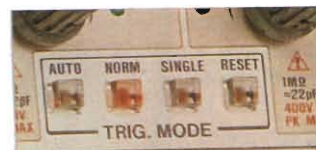
Fig. 3 - Riquadro del pannello del TRIO CS-2110 contenente i pulsanti per la scansione singola (SINGLE) ed automatica (AUTO).
