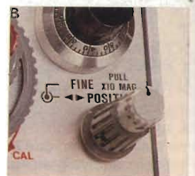
Fig. 5 - Estruendo la manopola piccola del comando FINE di posizione orizzontale viene attivata la funzione di espansione X10 della base dei tempi.
